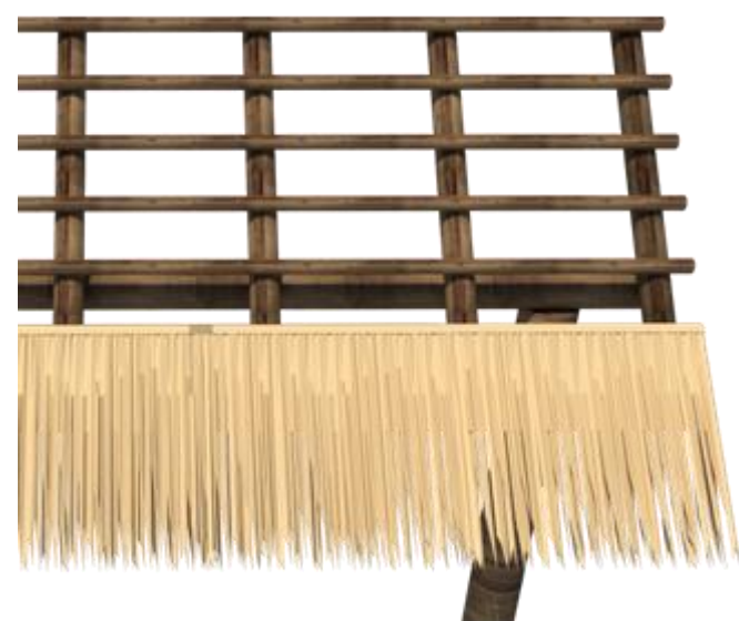
1ra Fila de Palma instalada [Comienza con una hoja completa]
