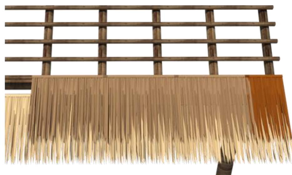
2da Fila de Palma instalada [Comienza con una hoja cortada a la mitad]
