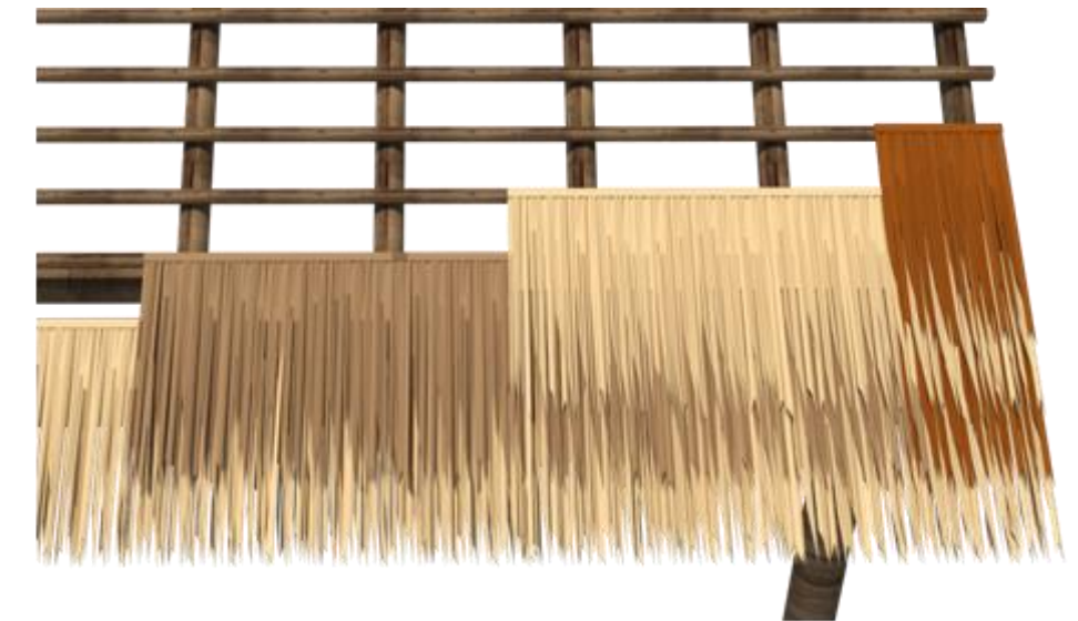
4ta Fila de Palma instalada [Comienza con una hoja cortada a la mitad]
